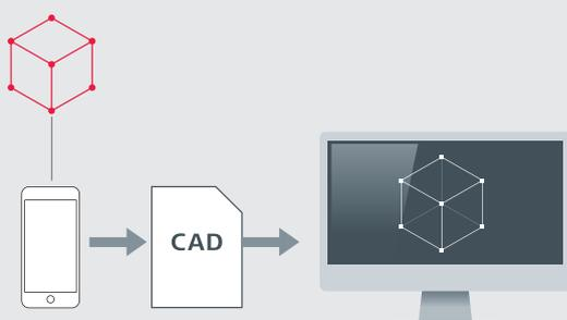
De nombreuses autres applications, comme AutoCAD® Mobile, sont disponibles pour une pleine exploitation des capacités du Leica DISTO™. Vous avez ainsi la possibilité de tracer des plans de chantier en temps réel et de partager vos données comme vos fichiers dxf avec d'autres personnes.
