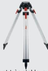
Trépied en aluminium léger et très stable, avec une vis de fixation 3/4", une nivelle et un verrouillage par serrage permettant une installation simple. Longueur d'extension de 0,75 m à 1,15 m. Idéal avec Leica FTA 360 ou FTA 360-S. Réf. 828 426
