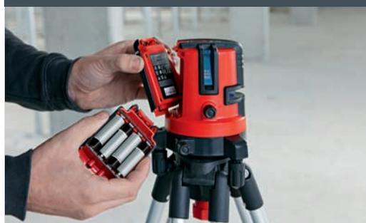
Les Leica Lino intègrent une batterie Li-ion qui garantit un travail continu. Une simple charge offre une autonomie de 24 h.
