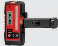
Un récepteur laser pour tous ! Boîtier IP 65 robuste avec affichage sur deux faces et aimants pour une fixation au plafond. Localisation de rayons laser à une distance jusqu'à 80 m. Pour Leica Lino L2, L2G, L2P5, L2P5G et L4P1. Réf. 866 090
