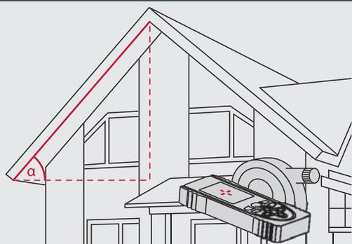
Cette technologie innovante permet de mesurer facilement et rapidement, à partir d'une seule position, la distance entre deux points quelconques. Les nouveaux encodeurs du Leica DST 360 et la Smart Base du Leica DISTO™ S910 se servent des informations d'angle pour offrir cette possibilité.
