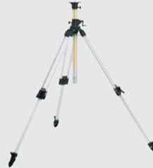
Trépied aluminium multifonctionnel, élévateur avec vis de fixation 5/8", bretelle, éléments de blocage rapides et nivelle, hauteur de travail 0,84 m – 2,46 m, avec échelle mm, pieds en caoutchouc remplaçables. Réf. 768 033
