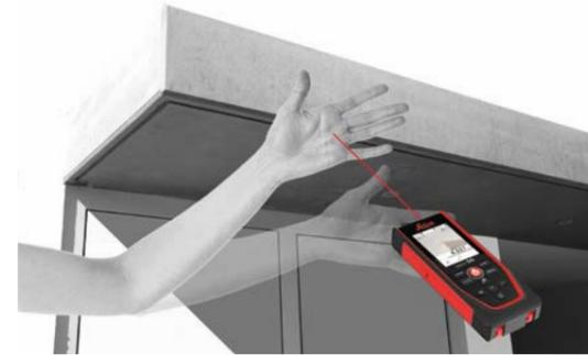
Durch das berührungslose Auslösen der Messung, bei dem der Laserstrahl mit der Hand kurz unterbrochen wird, löst Leica Geosystems ein weit verbreitetes Problem, nämlich dass der Laserdistanzmesser beim Auslösen der Messung bewegt wird. Dies zu vermeiden ist besonders wichtig, um auch bei großen Distanzen oder kleinen Zielen genaue Ergebnisse zu erhalten.
