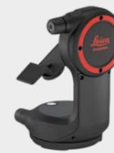
Der intelligente Adapter verwandelt den Leica DISTO™ X3 oder X6 in eine DISTO™ Station. Er ermöglicht P2P-Messungen mit dem Gerät oder wird zusammen mit der Leica DISTO™ Plan App sogar zum echten Planungstool. Art. Nr. 864 982 Adapter DST 360 für DISTO™ X3 Art. Nr. 946 095 Adapter DST 360-X für DISTO™ X6
