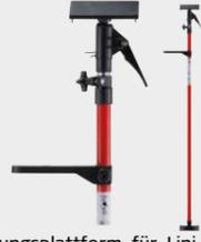
Mit universeller Befestigungsplattform für Linien- und Rotationslaser. Auszugslänge bis 2,90 m. Die Klemmstange lässt sich zwischen Boden und Decke fixieren. Das ermöglicht eine stufenlose Positionierung der Laser in unterschiedlichen Höhen. Art. Nr. 761 762
