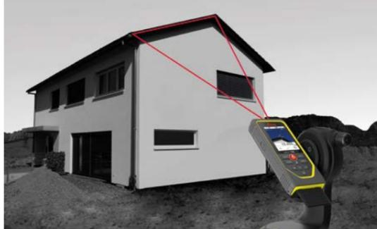
Mit dieser innovativen Technologie lässt sich die Distanz zwischen zwei beliebigen Punkten einfach und schnell von einer Position aus messen. Dazu nutzen die neuartigen Sensoren des Leica DST 360 / DST 360-X Adapters Winkelinformationen.
