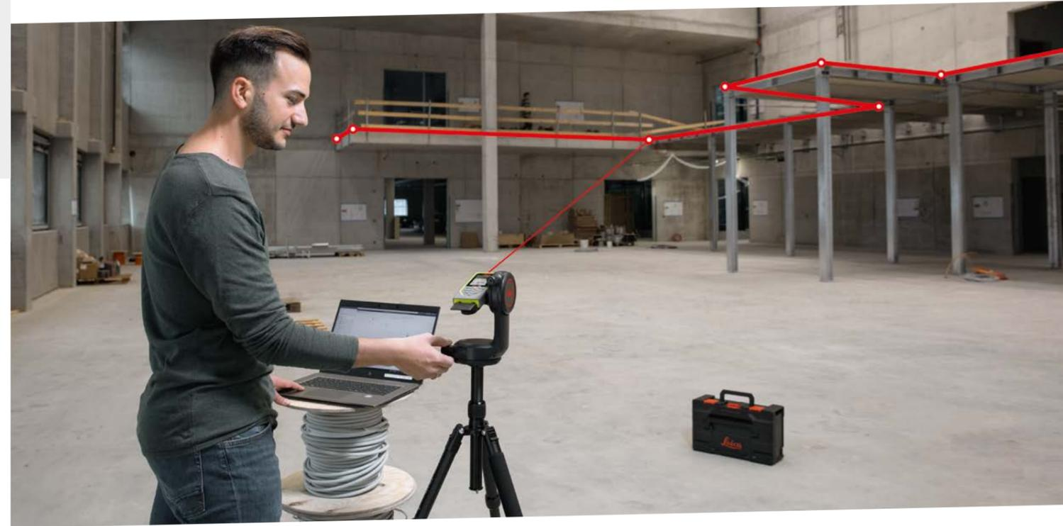
Die P2P-Technologie ist eine sichere, genaue und effiziente Messmethode, wenn es um Distanzmessungen in unzugänglichen Bereichen oder um komplexe Messsituationen geht. Außerdem ermöglicht sie einen vollständig digitalen Arbeitsprozess, da die erfassten Messergebnisse in jeder beliebigen CAD-Software weiterverarbeitet werden können.
