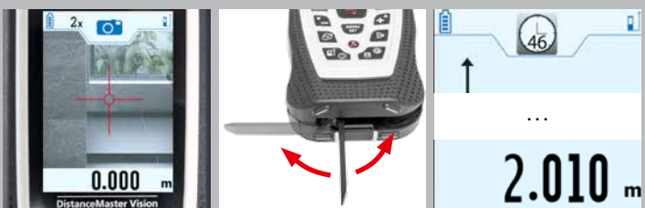
Viewfinder zum Anvisieren des Messbereichs
