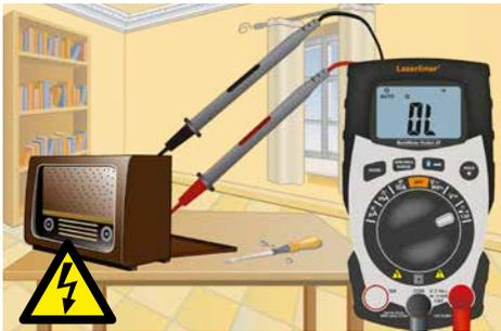
– **Diodentest-Funktion** zur Funktions- und Polaritätsbestimmung
