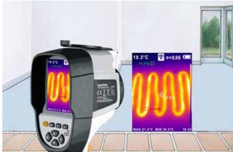
– Point de mesure central pour l'analyse de la température et mesure du point chaud/froid
