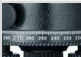
Horizontalkreis mit endlosem Seitenfeintrieb zum präzisen Anvisieren.
