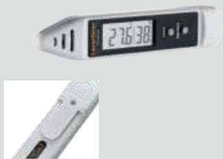
**Digitales Hygrometer zur Messung der relativen Luftfeuchte und Umgebungstemperatur mit Taupunktangabe**
