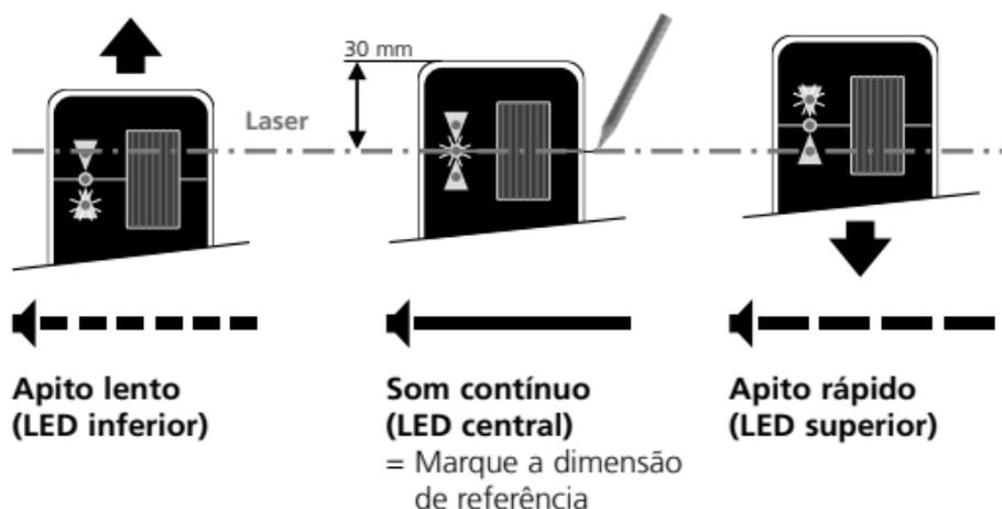
A intensidade da luz das linhas de laser é maior no meio e menor nas extremidades. Assim é possível que a margem de receção máxima do recetor laser diminua.
