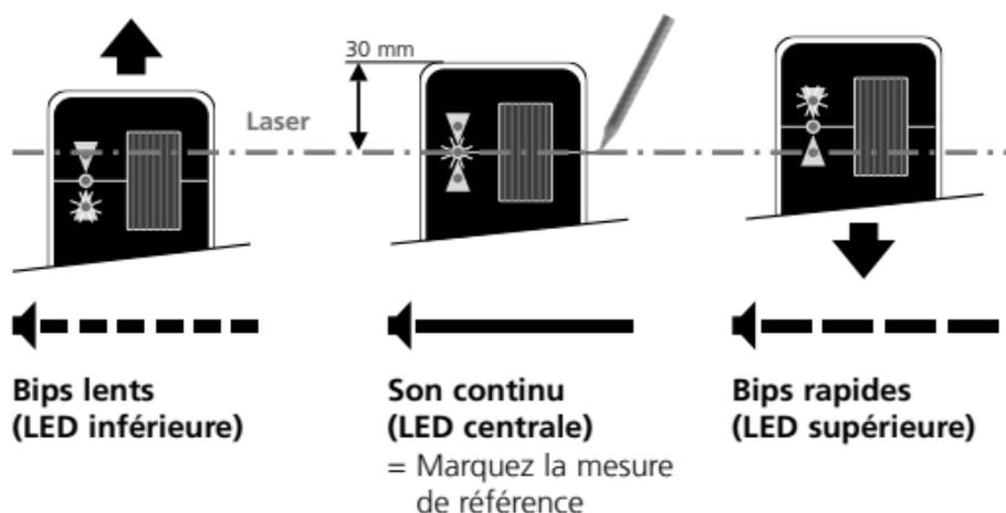
! L'intensité lumineuse des lignes laser est maximale au centre et va en diminuant sur les bords. Cela permet de réduire la plage de réception maximale du récepteur laser.
