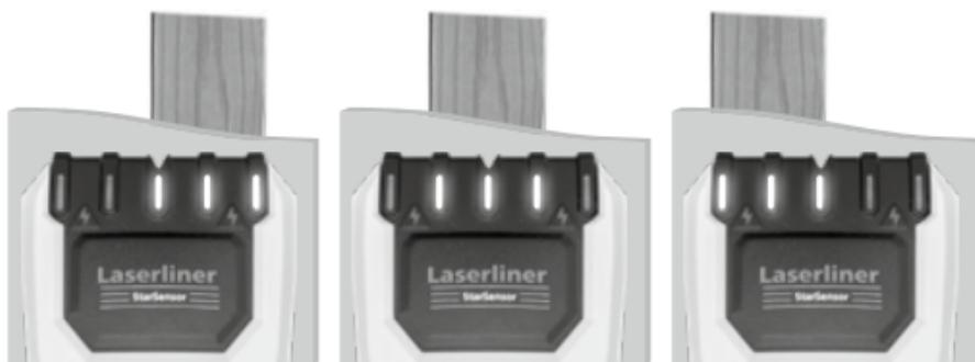
**Spänningsvarning:** Blixtsymbolerna lyser för att visa att det finns strömförande ledningar.
