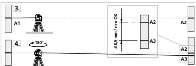
Quand A2 et A3 sont distants de plus de 0,5 mm / m l'un de l'autre, un réglage de l'appareil est nécessaire. Prenez contact avec votre revendeur ou appelez le service après-vente de UMAREX-LASERLINER.
