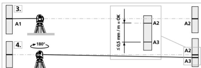
**!** Jos A2 ja A3 ovat toisistaan etäimmällä kuin 0,5 mm / m, on säätö tarpeen. Ota yhteys paikalliseen laitetoimittajaan tai UMAREX-LASERLINER huolto-osastoon.
