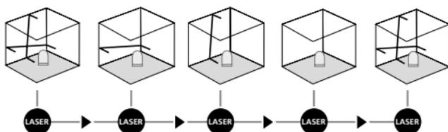
Undlad at løsne transportsikringen, og stil TIL/FRA-kontakten på "OFF". Aktivér og vælg laserne via valgtasten. Nu kan der anlægges skæve niveauer. I denne modus kan der hverken nivelleres horisontalt eller vertikalt, da laserlinjerne ikke længere indjusterer sig automatisk. Lysdioden (2) lyser konstant rødt.
