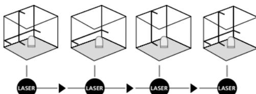
**!** Lai veiktu horizontālo un vertikālo līmeņošanu, jābūt atbrīvotam transporta drošinātājam. Pastāvīgi deg zaļa gaismas diode (2). Tiklīdz ierīce novirzās no automātiskās 5° līmeņošanas zonas, sāk mirgot lāzera stari un iedegas sarkana gaismas diode (2). Novietojiet ierīci tā, lai tā atrastos līmeņošanas zonā. No jauna iedegas zaļa gaismas diode (2) un lāzera stari deg pastāvīgi.
