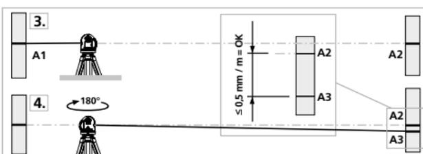
**!** Wanneer het verschil tussen punt A2 en A3 groter is dan de aangegeven tolerantie, nl. 0,5 mm / m, is een kalibratie nodig. Neem hiervoor contact op met uw vakhandelaar of met de serviceafdeling van UMAREX-LASERLINER.
