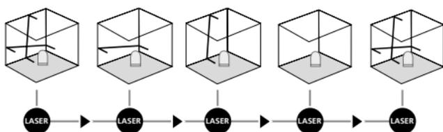
No soltar el seguro de transporte y cambiar el interruptor CON/DES a la posición „OFF“. Conectar y seleccionar los láser con la tecla de selección. Ahora pueden realizarse planos inclinados. En este modo no se puede nivelar horizontal o verticalmente, ya que las líneas láser no se orientan automáticamente. El LED (2) está encendido con luz roja constante.
