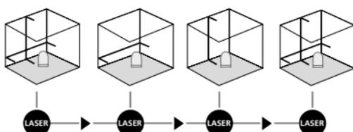
Horisontal og vertikal nivellering krever at transportsikringen løsnes. LED-en (2) lyser konstant grønt. Straks apparatet befinner seg utenfor det automatiske nivelleringsområdet på 5°, blinker laserlinjene og LED-en (2) lyser rødt. Posisjoner apparatet slik at det befinner seg innenfor nivelleringsområdet. LED-en (2) lyser grønt igjen og laserlinjene lyser konstant.
