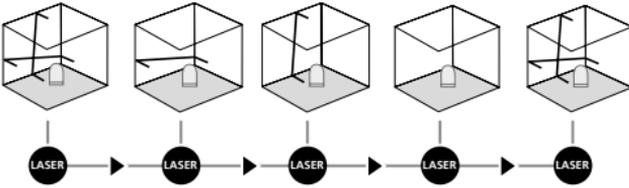
Deactiveer de transportbeveiliging niet, zet de AAN-/UIT-schakelaar op "OFF". Schakel de lasers in met de keuzetoets en maak vervolgens uw keuze. Nu kunnen schuine vlakken worden aangelegd. In deze modus kunt u niet horizontaal resp. verticaal nivelleren omdat de laserlijnen niet meer automatisch uitlijnen. De LED (2) brandt constant rood.
