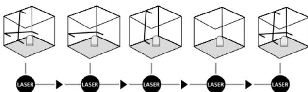
Não solte o bloqueador de transporte, coloque o botão para ligar/desligar em "OFF". Ligue e selecione os lasers com a tecla de seleção. A seguir podem ser traçados níveis inclinados. Neste modo não é possível nivelar horizontal e verticalmente, uma vez que as linhas de laser não se alinham automaticamente. O LED (2) acende constantemente com cor vermelha.
