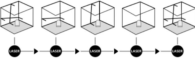
Не знімаючи з транспортного стопоріння, встановіть вимикач увімкнення/вимкнення на «OFF». Увімкніть лазері кнопкою вибору й оберіть режим. Тепер можна будувати похилі площини. У цьому режимі не можна здійснити горизонтальне або вертикальне нівелювання, тому що лазерні лінії вже автоматично не вирівнюються. Світлодіодний (2) індикатор світить червоним світлом, не блимаючи.
