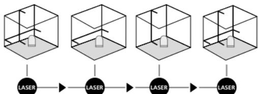
**!** Vaaka- ja pystysuuntaan tasaamista varten tulee kuljetusvarmistuksen olla vapautettuna. Punainen LED-valo (2) palaa jatkuvasti vihreänä. Kun laite on automaattisen tasausalueen 5° ulkopuolella, laserviivat vilkkuvat ja punainen LED-valo (2) syttyy. Sijoita laite tasaiselle alustalle niin, että laite on tasausalueella. Vihreä LED-valo (2) syttyy ja laserviivat palavat jatkuvasti.
