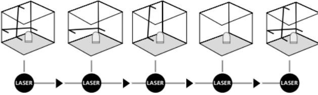
Non sbloccare la sicura di trasporto e portare l'interruttore ON/OFF in posizione "OFF". Con il tasto di selezione accendere e selezionare i laser. È ora possibile tracciare piani inclinati. In questa modalità non si può livellare orizzontalmente o verticalmente, in quanto le linee laser non si orientano più automaticamente. Il LED (2) emettono una luce rossa costante.
