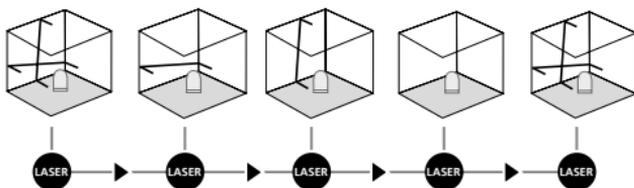
Не освобождавайте обезопасяването при транспорт, поставете превключвателя ВКЛ/ИЗКЛ на "OFF" (ИЗКЛ). Включете лазерите с бутона за превключване и изберете. Сега може да се зададат наклонени равнини. В този режим не може да се нивелира хоризонтално, съотв. вертикално, тъй като лазерните линии вече не се насочват автоматично. LED (2) свети постоянно в червено.
