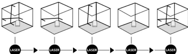
Не отпускать фиксатор для транспортировки, установить двухпозиционный выключатель в положение ВЫКЛ (OFF). Включить лазер с помощью клавиши выбора и выбрать направление лучей. Теперь можно получать наклонные поверхности. В этом режиме невозможно горизонтальное или вертикальное нивелирование, так как лазерные линии больше не центрируются автоматически. Постоянно горит красный светодиод (2).
