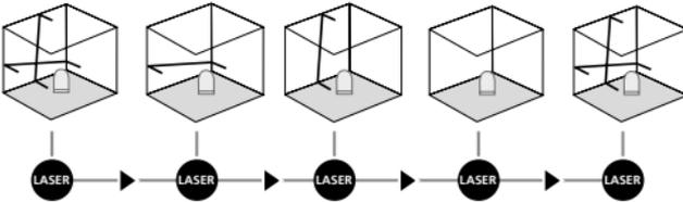
Ne pas dégager le blocage de transport, mettre l'interrupteur MARCHÉ/ARRÊT sur « OFF » (ARRÊT). Activer et sélectionner les lasers en appuyant sur la touche de sélection. Il est maintenant possible de travailler sur des plans inclinés. Il n'est pas possible d'effectuer un nivellement horizontal ou vertical dans ce mode étant donné que les lignes laser ne s'orientent plus automatiquement. La DEL (2) est allumée en permanence en rouge.
