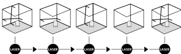
Nu îndepărtați siguranța de transport, poziționați întrerupătorul PORNIRE/OPRIRE pe "OFF". Laserul se pornește cu tasta de selectare și se selectează. Acum se pot marca suprafețele înclinate. În acest mod nu se poate nivela în plan orizontal resp. vertical, pentru că razele laser liniare nu se mai ajustează automat. LED-ul (2) luminează constant roșu.
