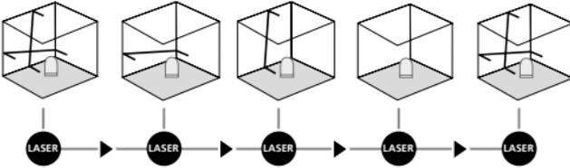
Die Transportsicherung nicht lösen, AN/AUS-Schalter (4) nach rechts schieben. Die Laser mit der Wahl Taste anschalten und auswählen. Jetzt können schiefe Ebenen angelegt werden. In diesem Modus kann nicht horizontal bzw. vertikal nivelliert werden, da sich die Laserlinien nicht mehr automatisch ausrichten. Die LED (2) leuchtet konstant rot.
