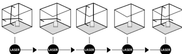
Neuvolňujte transportní pojistku, vypínač nastavte na "OFF". Zapněte lasery volicím tlačítkem a vyberte linii. Nyní je možné zalícit šikmé roviny. V tomto režimu není možné provádět horizontální resp. vertikální nivelaci, protože linie laseru se již automaticky nevyrovňávají. LED (2) svítí nepřerušovaně červeně.
