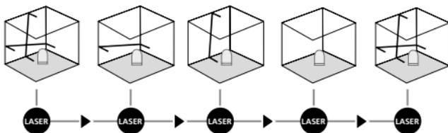
Prepravnú poistku neuvolňujte, spínač ZAP/VYP (4) posuňte doprava. Voliacim tlačidlom zapnite a zvolte lasery. Teraz môžu byť vytvorené šikmé roviny. V tomto režime nie je možná horizontálna, resp. vertikálna nivelácia, pretože laserové línie sa už automaticky nenasmerujú. Kontrolka LED (2) svieti konštantne načerveno.
