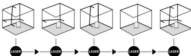
Neatlaisvinę transportavimo apsaugos, įjungimo ir išjungimo jungiklį pasukite į padėtį „OFF“. Pasirinkimo klavišu įjunkite ir pasirinkite lazerius. Dabar galima nustatyti pasvirusias plokštumas. Šioje padėtyje negali būti niveliuojama horizontaliai ar vertikalčiai, nes lazerio spinduliai nėra nustatomi automatiškai. Šviesos diodai (2) šviečia nuolatine raudona šviesa.
