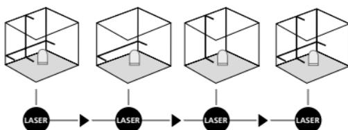
Para a nivelção horizontal e vertical é preciso que o bloqueador de transporte esteja solto. O LED (2) acende constantemente com cor verde. Logo que o aparelho se encontre fora da área de nivelção automática de 5°, as linhas de laser piscam e o LED (2) acende com cor vermelha. Posicione o aparelho de modo a que se encontre dentro da área de nivelção. O LED (2) volta a mudar para verde e as linhas de laser acendem constantemente.
