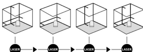
**!** Pro horizontální a vertikální nivelaci musí být uvolněná transportní pojistka. LED (2) svítí nepřerušovaně zeleně. Jakmile se přístroj nachází mimo rozsah automatické nivelace 5°, blikají laserové linie a LED (2) se rozsvítí červeně. Umístěte přístroj tak, aby se nacházel uvnitř rozsahu nivelace. LED (2) se opět rozsvítí zeleně a laserové linie svítí nepřerušovaně.
