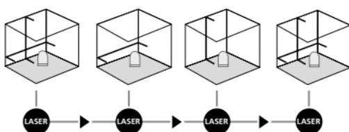
Для горизонтального и вертикального нивелирования необходимо снять с блокировки фиксатор для транспортировки. Постоянно горит зеленый светодиод (2). Как только прибор окажется за пределами автоматического диапазона нивелирования, равного 5°, лазерные линии и светодиод (2) начинают гореть красным цветом. Позиционировать прибор так, чтобы он находился в пределах диапазона нивелирования. Светодиод (2) снова изменяет свой цвет на зеленый, а лазерные линии светятся постоянно.
