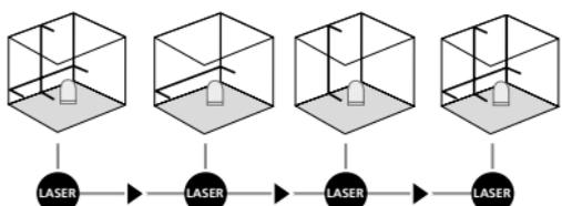
Para poder efectuar la nivelación horizontal y vertical tiene que estar suelto el seguro de transporte. El LED (2) está encendido con luz verde constante. Cuando el aparato se encuentra fuera del rango automático de nivelación de 5° las líneas láser parpadean y el LED (2) se enciende con luz roja. Coloque el aparato en una posición dentro del rango de nivelación. El LED (2) cambia de nuevo a luz verde y las líneas láser dejan de parpadear.
