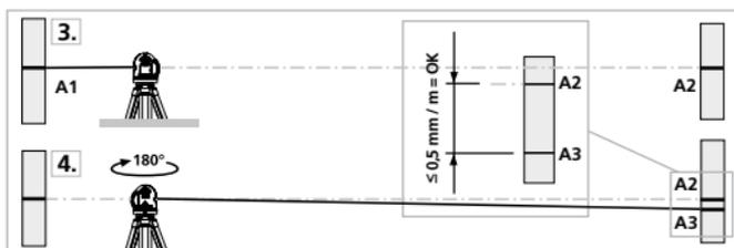
**!** Če sta A2 in A3 več kot 0,5 mm / m narazen, je treba napravo umeriti. Stopite v stik s prodajalcem ali pa se obrnite na servisni oddelek podjetja UMAREX-LASERLINER.
