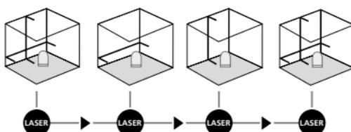
**!** Za vodoravno in navpično niveliranje je treba sprostiti transportno varovalo. LED-lučka (2) stalno sveti zeleno. Takoj, ko je naprava izven samodejnega območja niveliranja, ki znaša 5°, začnejo laserske linije utripati in LED-lučka (2) zasveti rdeče. Napravo postavite tako, da ne bo znotraj območja niveliranja. LED-lučka (2) bo znova preklopila na zeleno in laserske linije bodo stalno svetile.
