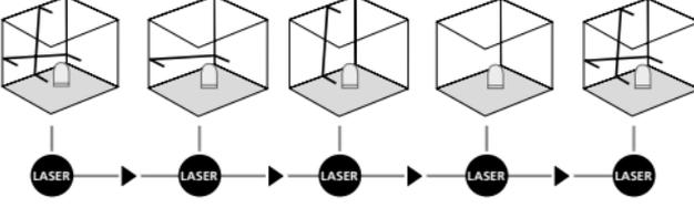
Taşıma emniyetini çözmeyiniz, AÇMA/KAPAMA şalterini "OFF" konumuna getiriniz. Lazerleri seçme şalteri ile çalıştırıp seçiniz. Şimdi eğimli düzlemler ayarlanabilir. Bu modda lazer çizgileri otomatik olarak ayarlanmadığından yatay ve düşey düzleştirme yapılamaz. Kırmızı LED (2) sabit şekilde kırmızı yanar.
