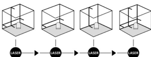
Il est nécessaire de dégager le blocage de transport pour procéder au nivellements horizontal et vertical. La DEL (2) est allumée en permanence en vert. Dès que l'instrument se trouve en dehors de la plage de nivellement automatique de 5°, les lignes laser clignotent et la DEL (2) s'allume en rouge. Positionner l'instrument de manière à ce qu'il soit dans la plage de nivellement. La DEL (2) passe de nouveau au vert et les lignes laser sont allumées en permanence.
