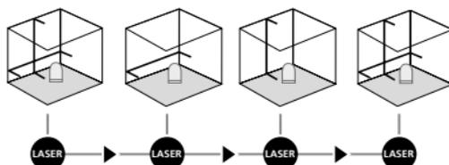
**!** Na horizontálne a vertikálne nivelovanie musí byť prepravná poistka uvoľnená. Kontrolka LED (2) svieti trvalo zeleno. Hneď ako sa prístroj nachádza mimo automatického nivelačného rozsahu 5°, laserové línie začnú blikať a LED (2) sa rozsvieti načerveno. Polohu prístroja nastavte tak, aby sa nachádzal v rámci nivelačného rozsahu. LED (2) sa zmení opäť nazeleno a laserové línie budú svietiť konštantne.
