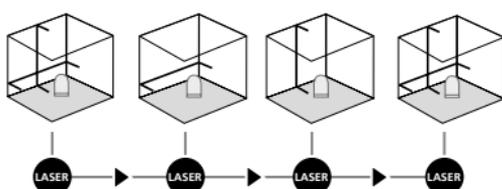
**!** Per il livellamento orizzontale e verticale si deve allentare la sicura di trasporto. Il LED (2) rimane acceso in verde. Non appena l'apparecchio si viene a trovare al di fuori del campo di livellamento automatico di 5°, le linee laser iniziano a lampeggiare e si accende la luce rossa del LED (2). Posizionare l'apparecchio in modo che si trovi all'interno del campo di livellamento. La luce del LED (2) diventa verde e le linee laser emettono una luce costante.
