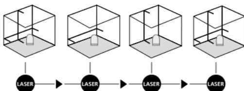
**!** Do niwelacji poziomej i pionowej zabezpieczenie transportowe musi być zwolnione. Dioda LED (2) świeci stałym zielonym światłem. Gdy urządzenie znajduje się poza automatycznym zakresem niwelacji wynoszącym 5°, linie laserowe migają, a dioda LED (2) świeci na czerwono. Ustawić urządzenie tak, aby znalazło się w zakresie niwelacji. Dioda LED (2) ponownie świeci na zielono, a linie laserowe świecą stale.
