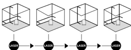
**!** Voor de horizontale en verticale nivellering moet de transportbeveiliging gedeactiveerd zijn. De LED (2) brandt constant groen. Zodra het apparaat zich buiten het automatische nivelleerbereik van 5° bevindt, knipperen de laserlijnen en brandt de LED (2) rood. Positioneer het apparaat zodanig dat het zich binnen het nivelleerbereik bevindt. De LED (2) schakelt weer over naar groen en de laserlijnen branden constant.
