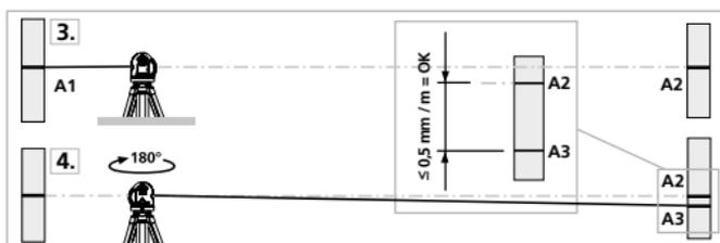
Si A2 y A3 se encuentran a más de 0,5 mm / m entre sí, será necesaria un ajuste. Póngase en contacto con su distribuidor especializado o diríjase al Servicio Técnico de UMAREX-LASERLINER.
