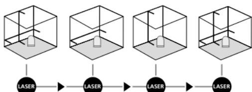
Til horisontal og vertikal nivellering skal transportsikringen være løsnet. LED (2) lyser konstant grøn. Så snart apparatet er uden for det automatiske nivelleringsområde på 5°, blinker laserlinjerne, og lysdioden (2) løser rødt. Apparatet skal positioneres således, at det er inden for nivelleringsområdet. Lysdioden (2) skifter igen til grønt, og laserlinjerne lyser konstant.
