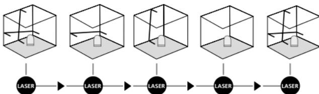
Lossa inte transportsäkringen, men ställ strömbrytaren i läget "OFF". Slå på och välj lasrar med valknappen. Nu kan lutande plan skapas. I detta läge kan inte horisontell eller vertikal nivellering göras, eftersom laserlinjerna inte längre justeras in automatiskt. Lysdioden (2) lyser konstant röd.
