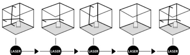
Μην λύνετε την ασφάλεια μεταφοράς, θέστε τον διακόπτη ON / OFF στο "OFF". Ενεργοποιήστε τα λέιζερ με το πλήκτρο επιλογής και επιλέξτε τα. Τώρα μπορούν να μετρηθούν κεκλιμένες επιφάνειες. Σε αυτή τη λειτουργία δεν μπορεί να γίνει οριζόντια ή κάθετη χωροστάθμηση, επειδή οι γραμμές λέιζερ δεν ευθυγραμμίζονται πλέον αυτόματα. Η LED (2) ανάβει συνεχώς κόκκινη.
