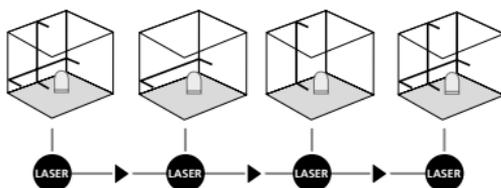
**!** Pentru nivelarea orizontală și verticală, siguranța pentru transport trebuie să fie îndepărtată. LED-ul (2) luminează constant verde. De îndată ce aparatul se află în afara domeniului de nivelare automată de 5°, razele laser pâlpâie iar LED-ul (2) luminează roșu. Poziționați aparatul astfel încât acesta să se afle în cadrul domeniului de nivelare. LED-ul (2) e aprinde din nou verde iar razele laser luminează constant.
