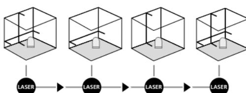
**!** Zum horizontalen und vertikalen Nivellieren muss die Transportsicherung gelöst sein. Die LED (2) leuchtet konstant grün. Sobald sich das Gerät außerhalb des automatischen Nivellierbereichs von 5° befindet, blinken die Laserlinien und die LED (2) leuchtet rot auf. Positionieren Sie das Gerät so, dass es sich innerhalb des Nivellierbereichs befindet. Die LED (2) wechselt wieder auf grün und die Laserlinien leuchten konstant.
