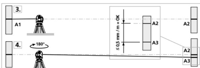
**!** Pokud jsou body A2 a A3 od sebe vzdáleny více než 0,5 mm / m, je nutné provést kalibraci. Spojte se s Vaším specializovaným prodejcem nebo využijte servisního oddělení společnosti UMAREX-LASERLINER.
