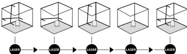
Älä avaa kuljetusvarmistusta, käynnä ON/OFF-kytkin asentoon OFF. Käynnistä ja valitse laserviiva valintapainikkeella. Nyt voit mitata kaltevia pintoja. Tässä tilassa ei voida linjata vaaka- tai pystysuorassa, sillä laserlinjat eivät enää tasaudu automaattisesti. Punainen LED-valo (2) palaa jatkuvasti.
