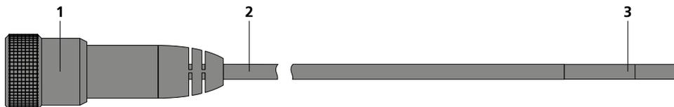
1 Место подсоединения базового блока
