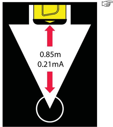
Il est bon de noter que la profondeur est calculée telle la distance par rapport au centre de l'installation !
