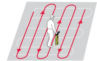
4. Repérez une installation en obtenant une lecture de crête. La lecture de crête s'obtient lorsque le localisateur se trouve directement au-dessus d'une installation et à 90° de celle-ci. Balisez la position d'une installation en utilisant de la peinture de repérage, des piquets, des fanions ou tout autre moyen similaire.
