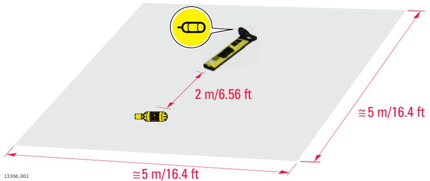
1. Réglez la sonde pour une utilisation sur une fréquence de 33 kHz.
