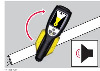
3. Lorsque les indicateurs d'intensité du signal affichent les niveaux les plus faibles, la lame du localisateur est alignée avec l'installation indiquant ainsi sa direction.
