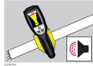
2. Faites pivoter le localisateur sur son axe jusqu'à ce que les indicateurs d'intensité du signal affichent les niveaux les plus faibles.
