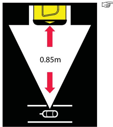
Il est bon de noter que la profondeur est calculée telle la distance par rapport à la sonde située à l'intérieur de la conduite !
