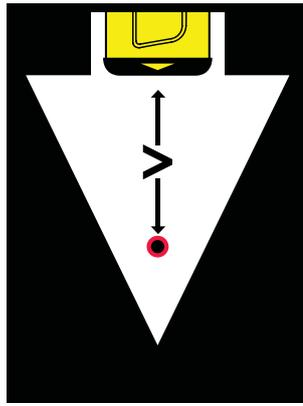
Cet écran indique que la profondeur de l'installation ou de la sonde est supérieure à valeur maximale de la plage de profondeur.
