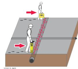
3. Lorsqu'une installation détectable est repérée, le localisateur émet un son et les indicateurs d'intensité du signal augmentent et diminuent lorsque vous passez au-dessus de l'installation. Retournez au point où l'écran de localisation affiche une lecture de crête. Balisez la position d'une installation en utilisant de la peinture de repérage, des piquets, des fanions ou tout autre moyen similaire.
