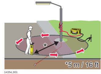
8. Lorsqu'une installation détectable est repérée, le localisateur émet un son et les indicateurs d'intensité du signal augmentent et diminuent lorsque vous passez au-dessus de l'installation. Retournez au point où l'écran de localisation affiche une lecture de crête. Balisez la position d'une installation en utilisant de la peinture de repérage, des piquets, des fanions ou tout autre moyen similaire.
