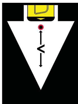
Cet écran indique que la profondeur de l'installation ou de la sonde est inférieure à la valeur minimale de la plage de profondeur.
