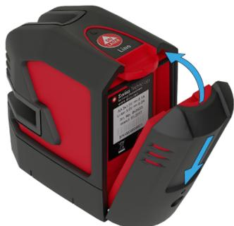
Insérer le bloc de batterie en pressant dessus, puis en l'inclinant vers le logement, conformément à l'illustration, jusqu'à ce qu'il s'encliquète.
